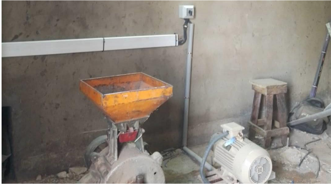
Figure 22 : À droite, le premier moteur alimentant la machine à faire de la pâte d'arachide
