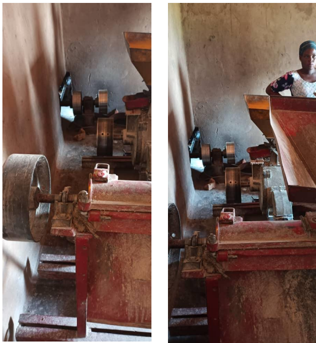
Figure 3 : Une décortiqueuse type « Engelber » pour enlever le son du Maïs et un moulin pour produire de la farine de maïs.
