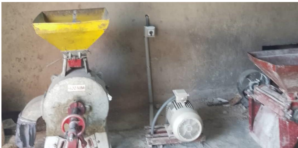
Figure 23 : Le second moteur au milieu alimente la décortiqueuse à droite et le moulin à gauche.
