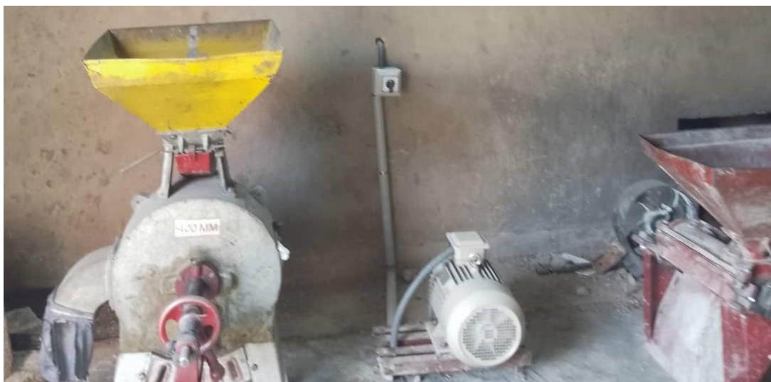
Figure 11 : Le second moteur au milieu alimente la décortiqueuse à droite et le moulin à gauche.
