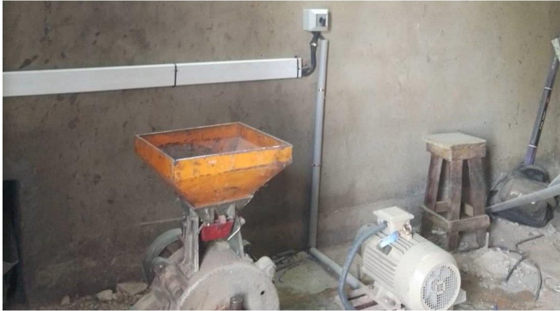
Figure 10 : À droite, le premier moteur alimentant la machine à faire de la pâte d'arachide
